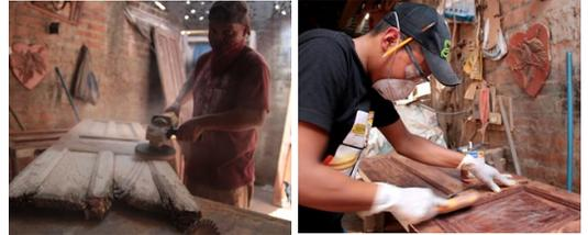
Parte del proceso de restauración de las puertas; a la izquierda, se muestra el uso de una lija para remover las diferentes capas de pintura, mientras que a la derecha, se observa que se pasa un cepillo de alambre.
