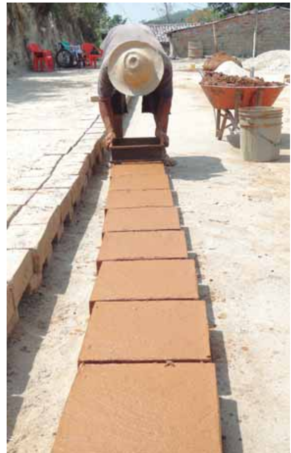
Elaboración de adobes de tierra
