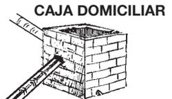
3. De la caja domiciliar sale una tubería que conecta a una caja de control en el pasaje, a donde llegan otras tuberías que canalizan las aguas servidas de lavaderos, baños e inodoros de otras viviendas.
